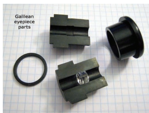
Figure 2 : pièces constituant l'oculaire de Galilée
